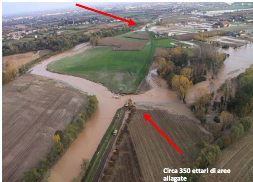
... ma il problema è la rottura dell'argine e dunque la modellazione idrologica, ed **idraulica** deve seguire anche una **modellazione (geotecnica)** degli argini e della loro **probabilità di rottura**.
